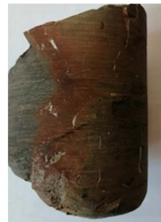
Рис. 2. Керн из баженовской свиты со следами гидротермального воздействия (Нонг-Еганское месторождение, P130, глубина отбора 2858,5 м)
