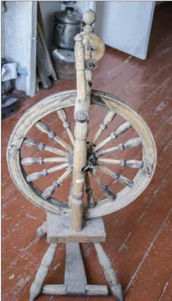
Скало (скально). Прибор для перемотки пряжи. 1-я пол. XX в. Дерево, металл. Токарная резьба. Музейный уголок в Доме культуры с. Неверкино Неверкинского района.
